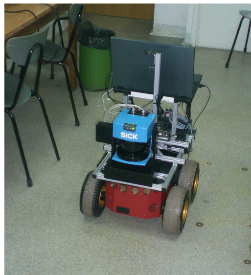
Rys. 1. Robot PIONEER 3AT z laserowym systemem pomiarowym 3D.
