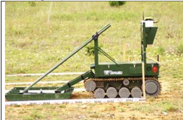
Figure 5. TeODOR – VALLON Metal Detector Array
