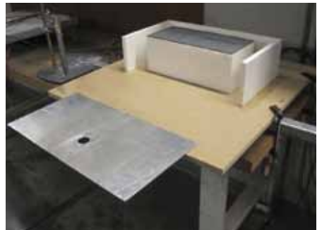
De CERL- opstelling (links) en de Lego®-opstelling (rechts) met de cirkelvormige uitsparing voor de positionering van de explosieve lading
